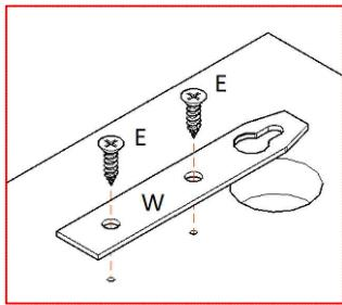
2. Fixe as buchas plásticas na parede nos pontos onde o móvel será fixo. Estes pontos são dados tomando como referência os furos da travessa traseira localizada dentro do balcão. Recomendamos que o móvel seja suspenso na altura que proporcione maior conforto aos usuários.
