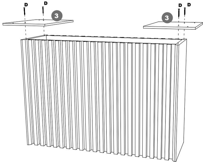
Fixe os 2 apoios do tampo (3) no topo da estrutura da base, montada anteriormente, utilizando os parafusos 5x50 (F).
