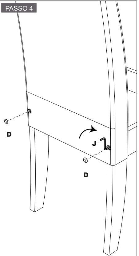
Utilizando a chave allen (J), aperte os parafusos até que fiquem bem firmes. Depois, cubra-os utilizando as tampas (D).
