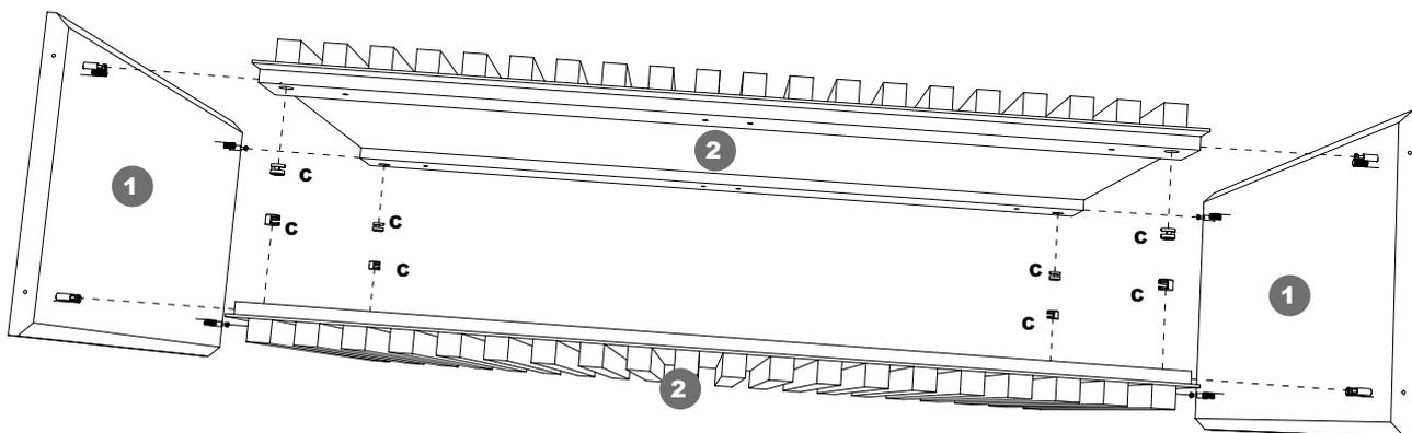
Encaixe os painéis ripados (2) nas laterais (1) utilizando as cavilhas (A) como guias. Depois fixe a estrutura da base utilizando os tambores mini-fix (C).
