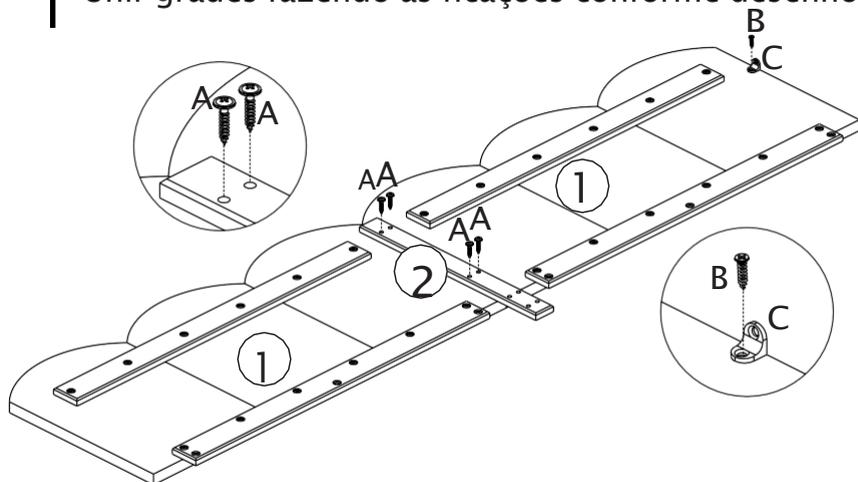
2 Posicionar as grades na cama e fazer as fixações conforme ilustração e detalhes abaixo.
