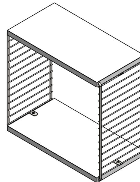
**3º Passo** - Fixe as duas cantoneiras plásticas na parte superior da prateleira com parafuso cabeça chata phillips Ø3,5 x 14mm (uma de cada lado), posicione e marque com um lápis as posições dos furos na parede, em seguida fure e fixe o cubo com bucha e parafuso. Fechar a cantoneira com a tampa.
