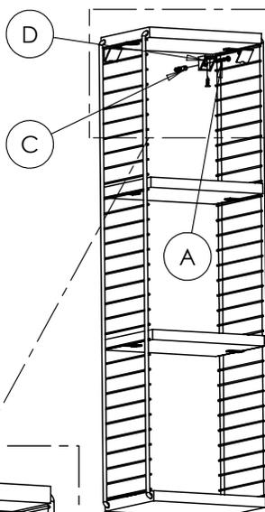
4º - Fixe a cantoneira plástica na parte superior da prateleira, posicione e marque as posições dos furos na parede, em seguida fure e fixe o cubo com bucha e parafuso.
