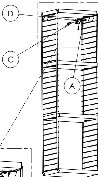
4º - Fixe a cantoneira plástica na parte superior da prateleira, posicione e marque as posições dos furos na parede, em seguida fure e fixe o cubo com bucha e parafuso.
