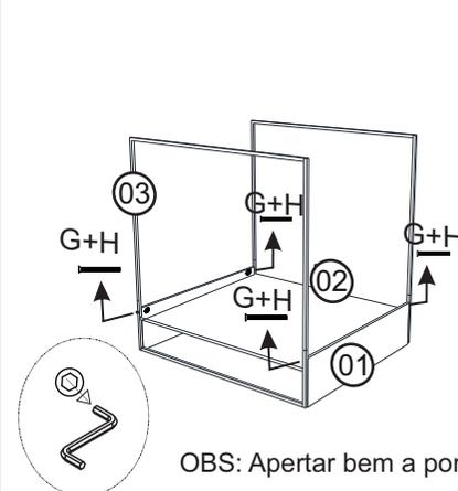
**6** Coloque o couro I sobre a peça nº3 e fixe na base nº2 com o parafuso B.
