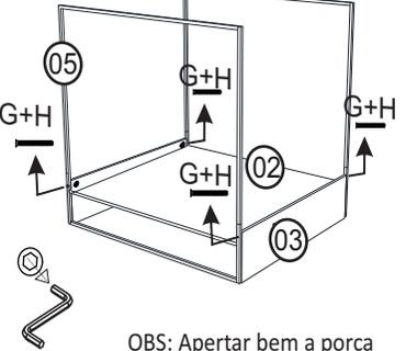
**6** Coloque o couro I sobre a peça n°5 e fixe na base n°2 com o parafuso B.
