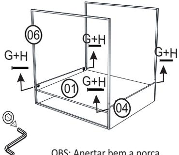
**6** Coloque o couro I sobre a peça n°6 e fixe na base n°1 com o parafuso B.
