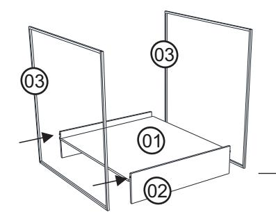
5 Coloque os parafusos G na peça nº3 e nº2. Use a chave zeta H para apertar.
