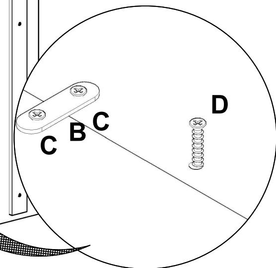
PARA FIXAÇÃO DAS REGUAS DO PAINEL, UTILIZAR OS PARAFUSOS D 3,5 X 25, CERTIFIQUE QUE AS REGUAS ESTARÃO CENTRALIZADAS.
