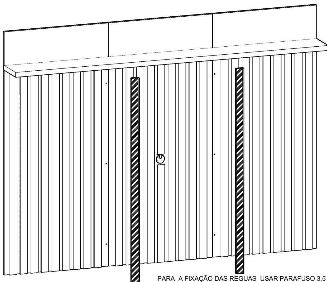
PARA A FIXAÇÃO DAS REGUAS USAR PARAFUSO 3,5 x 25 **D**
