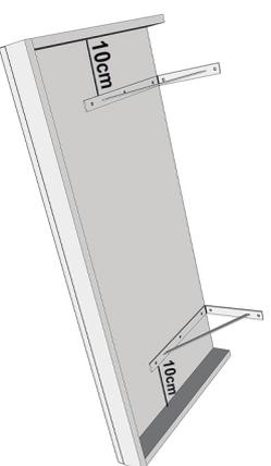
Fixar o espelho frontal na parede com silicone, bem como, aplicar uma camada de silicone na base do espelho para vedação conforme o desenho.
