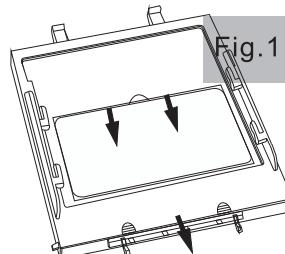
Em seguida, flexione a parte superior do filtro para permitir a remoção do filtro antigo.
