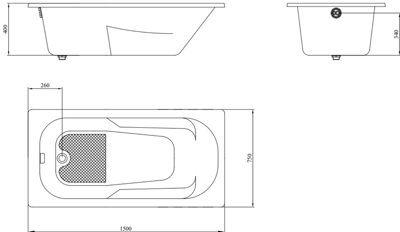
Dimensões 1500mm comprimento x 750mm largura x 400mm altura
