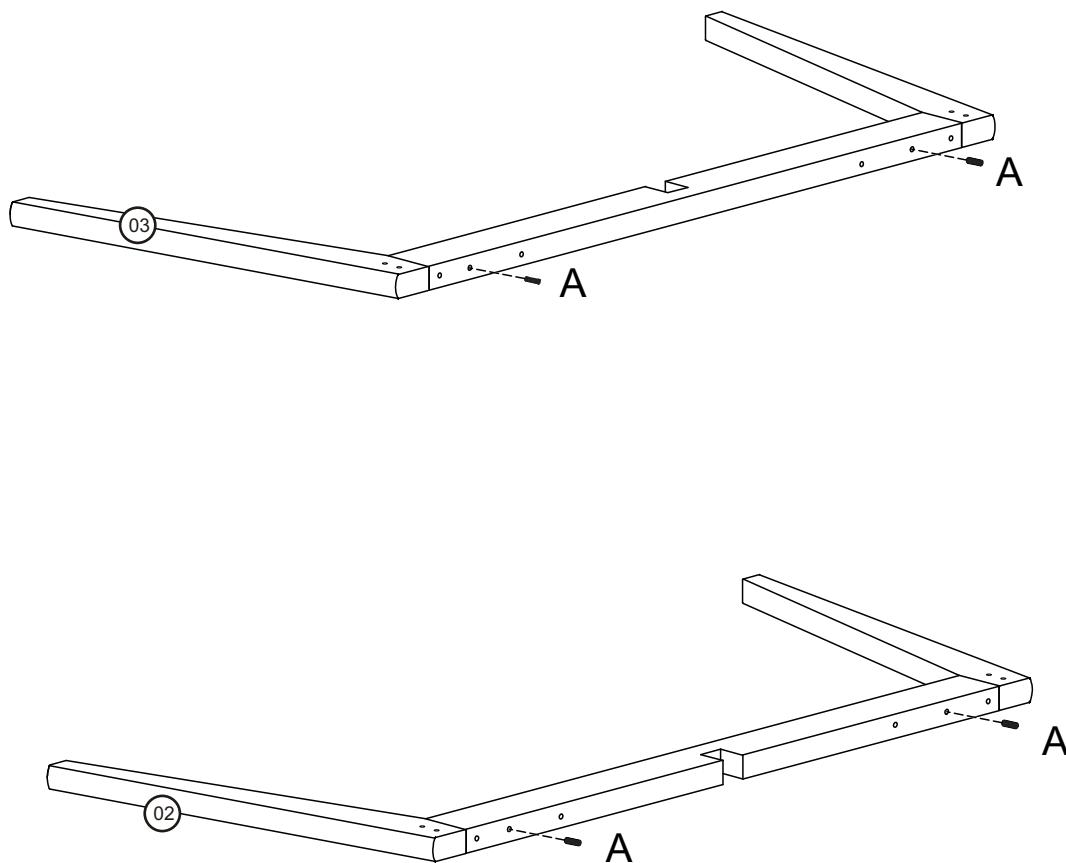
2 Encaixar a Peça (02) na Peça (03), conforme abaixo.
