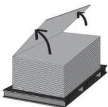
Manuseio das placas cimentícias para retirada dos paletes.
