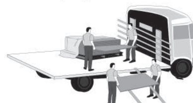
Transporte e proteção de placas cimentícias.
