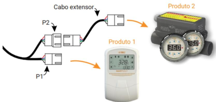
Ao conectar um Smart Plus (equipamento expansor de saídas auxiliares da linha Tholz Casa Inteligente) no conector secundário P2, através do cabo extensor, o dispositivo o identificará como uma expansão do produto conectado em P1. Nesta situação o aplicativo exibirá as saídas auxiliares do Smart Plus junto às saídas do produto primário.
