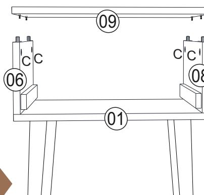
**4** Coloque e aperte os parafusos D na peça n°1.
