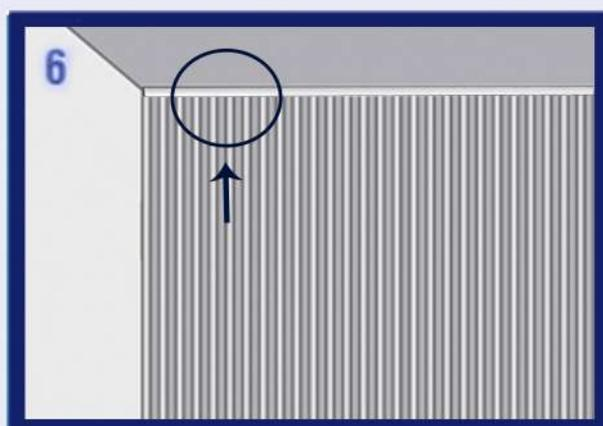
Aplique lentamente a peça na quina do painel Ripado já instalado pressionando-a para uma melhor fixação. Obs: Caso opte pela utilização de cola, utilize um pano seco para limpar o excesso de cola caso houver.
