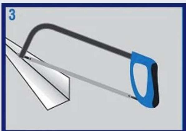
Após medir o local onde o acabamento L PVC será instalado, corte a peça no tamanho correto caso necessite.
