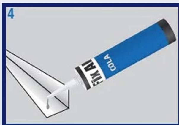
Com a peça no tamanho correto, escolha a forma de fixação do acabamento no Painel, a mesma pode ser fixada com cola ou fita dupla face.
