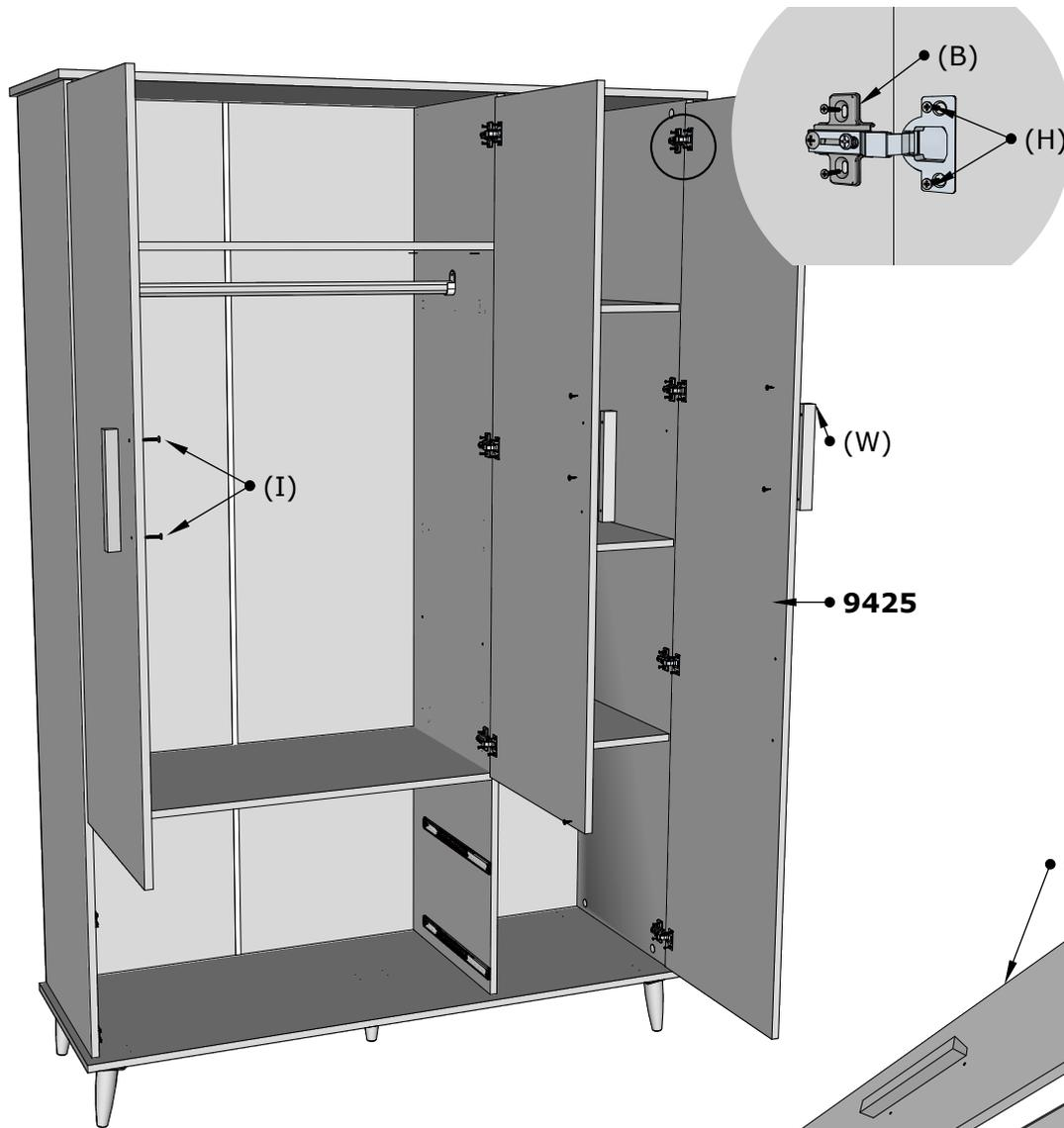
**8º Passo:** Montar as portas menores (9426) e (9427). Usando dobradiças (B) e parafuso 3,5x14 (H).
