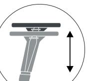
Ajuste de profundidade: movimento a parte superior do apoio para frente ou para trás até encontrar a posição desejada.
