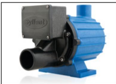
**MOTOBOMBA:** Item responsável para circulação da água na SPA. Seu design autodrenante permite o escoamento da água das tubulações e do corpo da própria bomba, evitando a ocorrência de aromas desagradáveis e desperdício de água com limpezas de tubulações, sendo também
