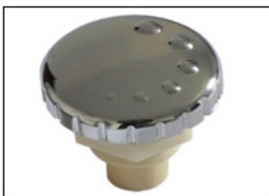
**VÁLVULA DE CONTROLE DE AR:** Controla a quantidade de ar na mistura ar mais água nos jatos de hidromassagem. Girando no sentido horário reduz-se quantidade de ar misturada na água, diminuindo a quantidade de bolhas.
