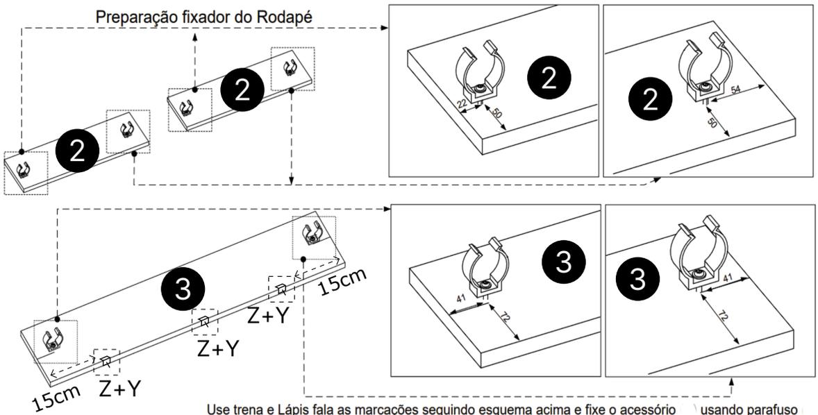
Use trena e Lápis para as marcações seguindo esquema acima e fixe o acessório usando parafuso
