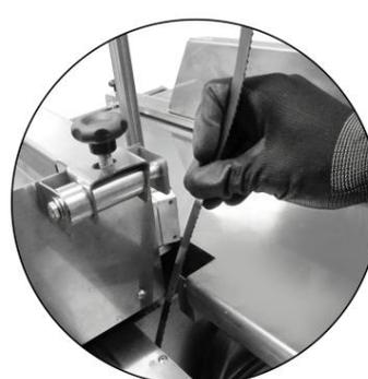
10. Retire a lâmina passando-a na fenda entre a mesa fixa e mesa móvel, e desviando da proteção inferior da lâmina;
