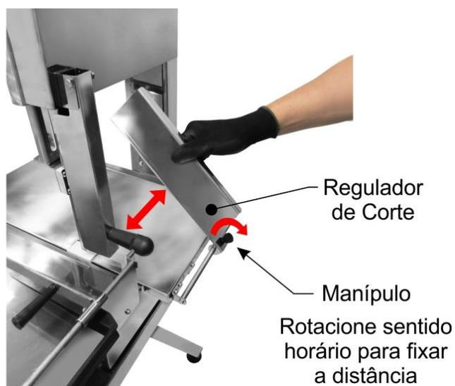
3. Ajuste a distância entre a proteção da lâmina e o alimento para que a área exposta da lâmina seja apenas o necessário para realizar o corte. Para movimentar a proteção para cima ou para baixo, rotacione no sentido anti-horário o manipulador próximo da guia. Para fixar a distância, rotacione no sentido horário;
