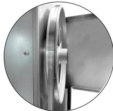
Centralizar a lâmina nos volantes
