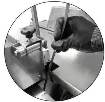
10. Retire a lâmina passando-a na fenda entre a mesa fixa e mesa móvel, e desviando da proteção inferior da lâmina;
