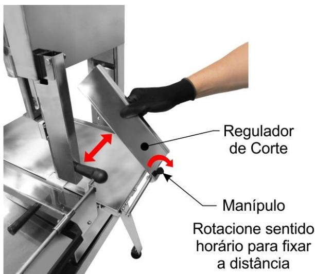
3. Ajuste a distância entre a proteção da lâmina e o alimento para que a área exposta da lâmina seja apenas o necessário para realizar o corte. Para movimentar a proteção para cima ou para baixo, rotacione no sentido anti-horário o manípulo próximo da guia. Para fixar a distância, rotacione no sentido horário;
