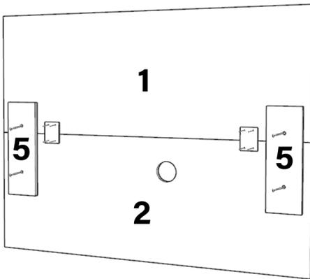
UNIR PAINÉIS "1, 2" USANDO CHAPA DE CONEXÃO "G2" E PARAFUSOS "P1".
