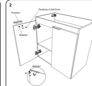
Fixe os puxadores com os Parafusos 4,2x9,5 mm Cabeça Plana lembrando de colocar os batedores entre o parafuso e puxador .
