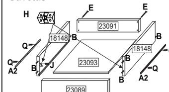
Gavetas - Parafusar as laterais de gaveta ao lenço da gaveta com o parafuso (E); encaixar o fundo no rasgo e fixe a frente com a cavilha (B) e cantoneira (H); a corredeira (A2) deve ser parafusada na lateral (18148) com o parafuso (Q) na posição horizontal.
