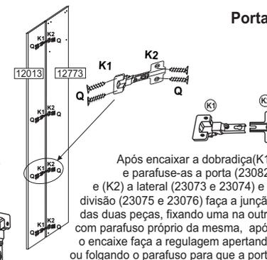
Após encaixar a dobradiça (K1) e parafusar-as a porta (23082) e (K2) a lateral (23073 e 23074) e a divisão (23075 e 23076) faça a junção das duas peças, fixando uma na outra com parafuso próprio da mesma, após o encaixe faça a regulagem apertando ou folgando o parafuso para que a porta fique firme e bem posicionada.
