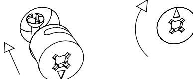
Encaixe as peças 2 na peça 1, como mostra na imagem. Em seguida repita o passo 6, colocando e fixando os tambores (A):
