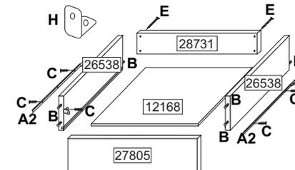
**Gavetas** - Parafusar as laterais de gaveta ao lenço da gaveta com o parafuso (E); encaixar o fundo no rasgo e fixe a frente com a cavilha (B) e cantoneira (H); a corrediça (A2) deve ser parafusada na lateral (26538) com o parafuso (C) na posição horizontal.
