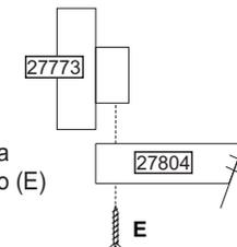
**Moldura** - Parafusar a moldura com parafuso (E) ao tampo(27804).
