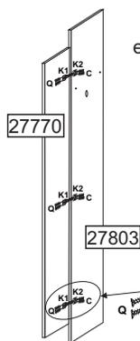
Após encaixar a dobradiça(K1) e parafuse-as a porta (27770) e (K2) a lateral (27765 e 27803) e a divisão (27766 e 27767) faça a junção das duas peças, fixando uma na outra com parafuso próprio da mesma, após o encaixe faça a regulagem apertando ou folgando o parafuso para que a porta fique firme e bem posicionada.
