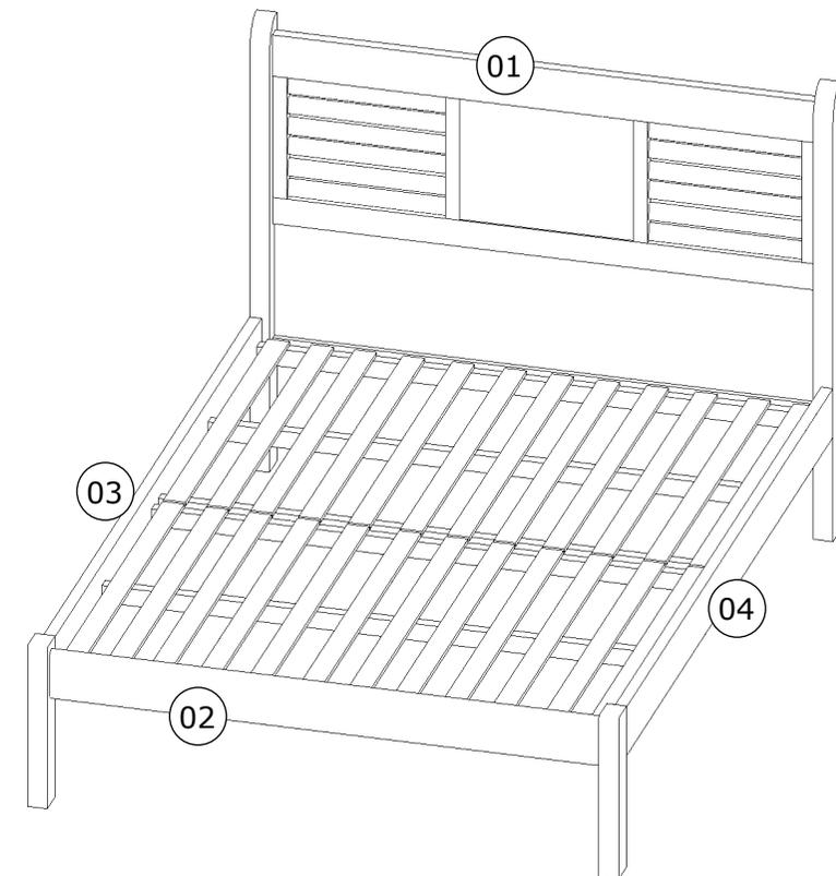
\* A fixação das barras é feita com parafuso Philips 150mm, cavilhas, arruelas e porcas;
