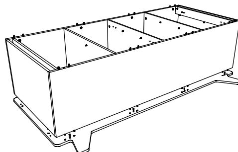
Encaixe a peça 1 na estrutura já montada e repita o passo 6 colocando os tambores (A) e fixando as peças:
