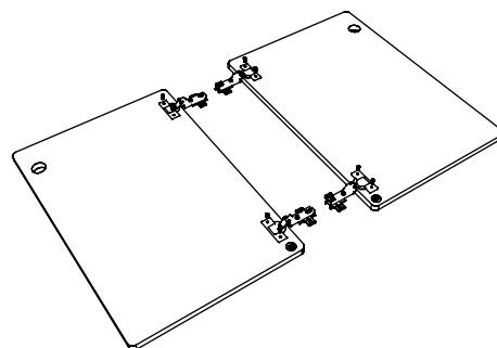
Com as dobradiças já instaladas, parafuse as porta 01 nas peças 5 e 9 usando os parafusos (E), como mostra a imagem:
