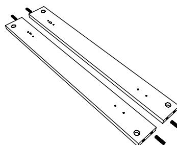
Repita o passo 2 colocando as cavilhas de madeira (C) nos furos laterais das peças 7 e 8. Em seguida, coloque os suportes de prateleiras (L) nos furos pequenos das faces das peças. Repita esse passo em todas as peças 7 e também nas peças 9 e 10:
