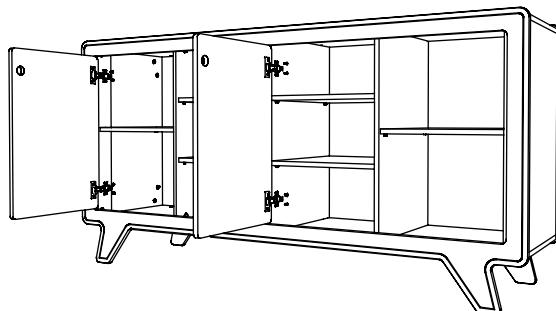
Em seguida, parafuse as portas 02 nas peça 9 e 6 usando os parafusos (E):
