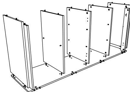
Em seguida, encaixe a peça 4 na estrutura já montada e repita o passo 6 colocando os tambores (A) e fixando as peças:
