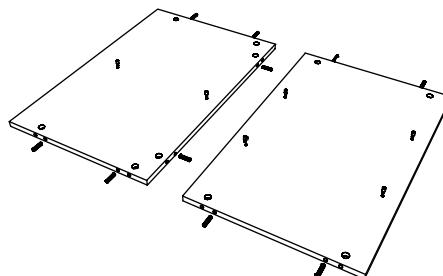
Com a peça 3 no chão, comece colocando os parafusos (B) em todos os furos pequenos da face da peça. Depois, repita o passo 2 colocando as cavilhas de madeira (C) nas laterais da peça como mostra na imagem. Repita este passo com a peça 4:
