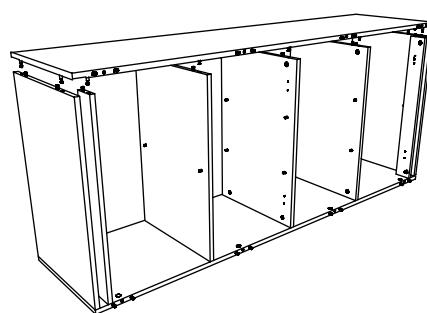
Encaixe a estrutura já montada anteriormente na peça 2, como mostra a imagem. Em seguida repita o passo 6, colocando os tambores (A) em todos os furos grandes e fixando as peças com a ajuda da chave Philips:
