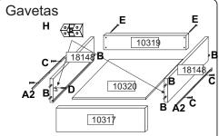
Gavetas - Parafusar as laterais de gaveta ao lenço da gaveta com o parafuso (E); encaixar o fundo no rasgo e fixe a frente com a cavilha (B) e cantoneira (H); a corrediça (A2) deve ser parafusada na lateral (18148) com o parafuso (C) na posição horizontal. Fixe o puxador com o parafuso (R).
