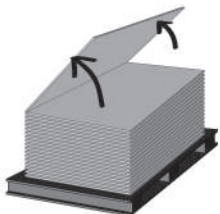
Manuseio das placas cimentícias para retirada dos paletes.
