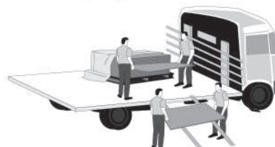
Transporte e proteção de placas cimentícias.
