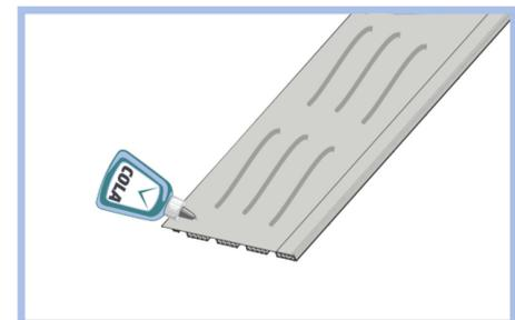
Outra opção de fixação do painel é colar com cola Pu. Deve ser aplicado de uma extremidade a outra do revestimento.
