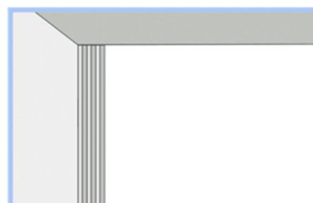
Coloque o revestimento na posição de instalação e pressione contra a parede para fixação.
