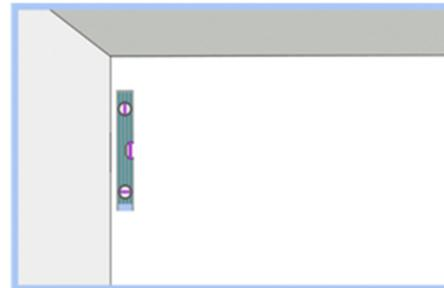
Defina o local em que o Painel Ripado será instalado. Realize a limpeza do local. Sugerimos que marque com o lápis na parede, para que fique alinhado...
