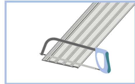
Após a marcação da superfície, efetue o corte das placas na medida desejada (caso precise).
