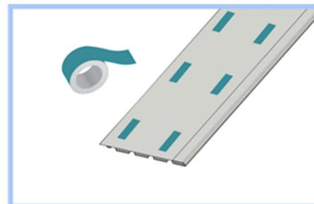
Após fazer o corte das placas, aplique no verso do Painel pedaços de fita dupla face (pedaços de 5 cm) em intervalos de até 25 cm...
