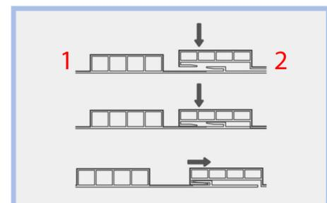
De seqüência na instalação encaixando uma peça a outra conforme demonstra na imagem acima.
