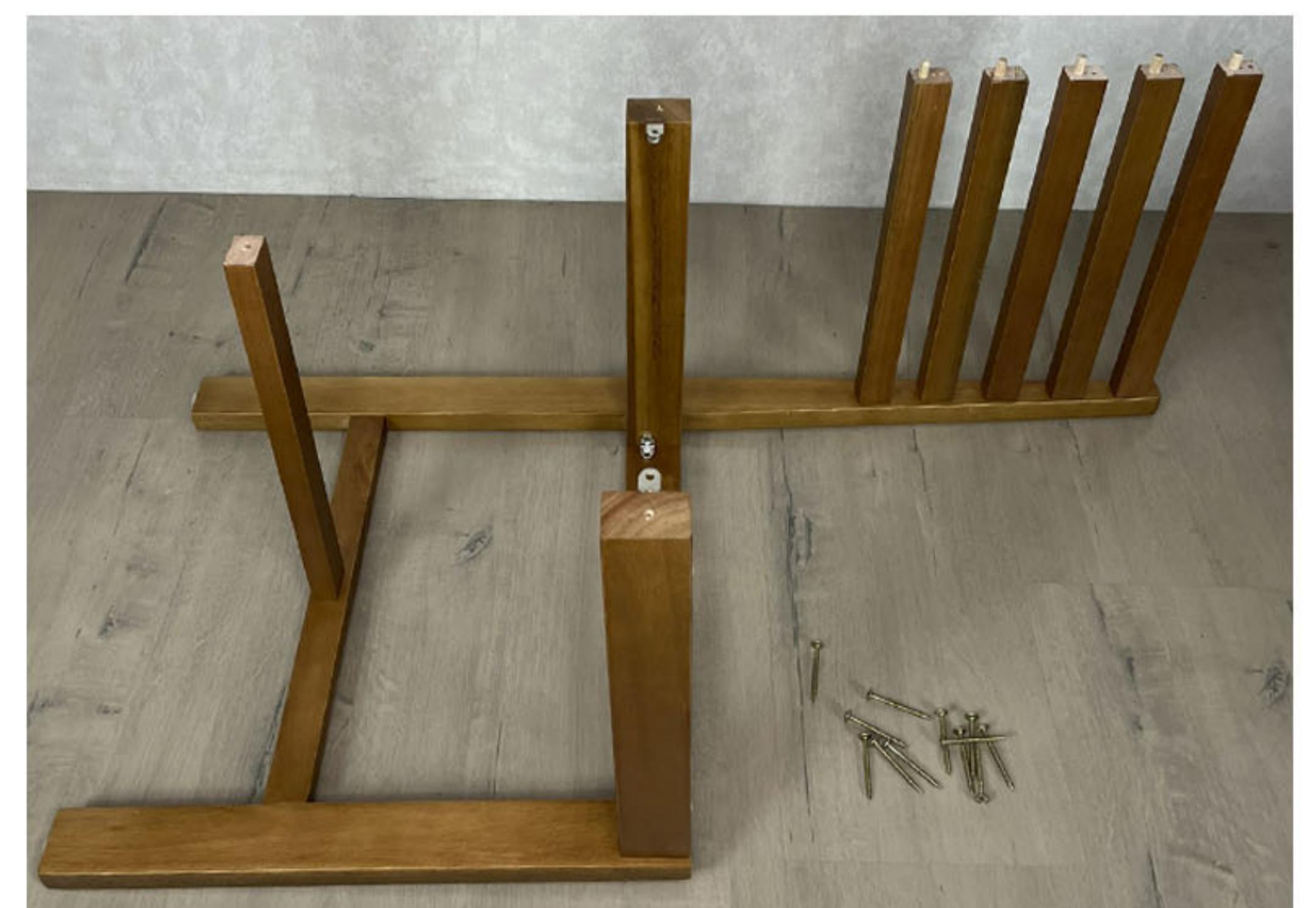
Passo 3: Encaixe a outra lateral na estrutura montada até o momento. Dica: Encaixe primeiro as cavilhas e acerte os parafusos, para só depois fixar com parafusadeira
