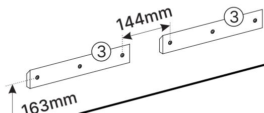
Siga as medidas desse passo para fixar os calços na parede, se caso haja mais painéis mantenha 144mm entre furos de cada calço.
