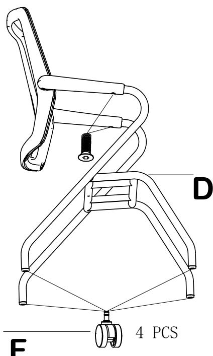
Ainda com o parafuso M6 x 12MM (**A**) em mãos fixe o assento com os braços à estrutura (**D**) e encaixe os rodízios (**F**).
