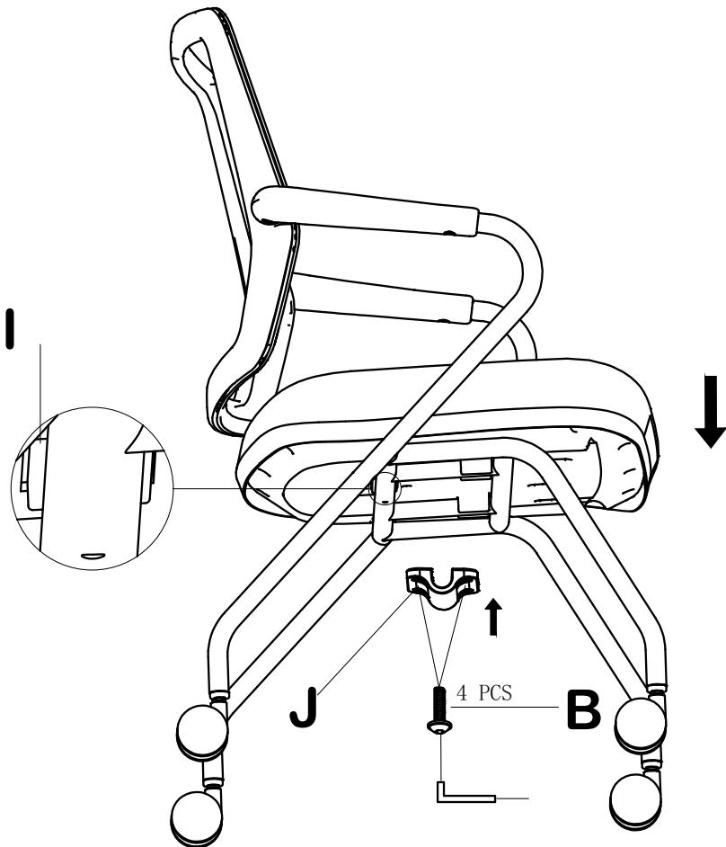
Encaixe a estrutura (D) nos suportes das almofadas (I) e utilize a trava (J) junto com os parafusos M6 x 30 (B) para fixar a estrutura à almofada, utilize uma chave allen M6 para garantir o aperto dos parafusos.
