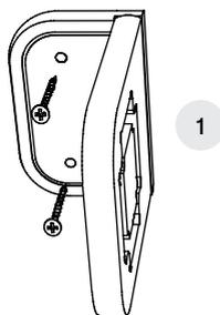
Primeiramente, parafuse a peça 1 na parede, como mostra a figura.
