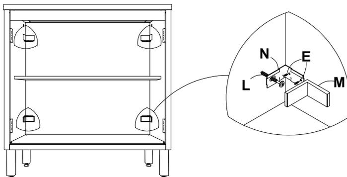
10º - Fixe a porta na lateral esquerdo e lateral direita com "G" Parafuso CH PHS 3,5x28 c/ pont.
