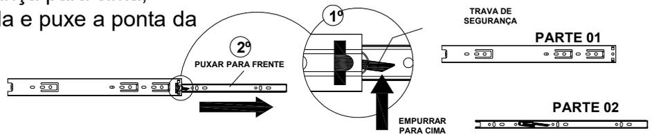
**22º** - Parafuse a parte **01 da corrediça (desenho abaixo)** na lateral inferior direita e na divisão inferior direita, seguindo as marcações, usando **03 parafusos Ch. Ph. 3,5x10 c/ pt.** para cada corrediça.
