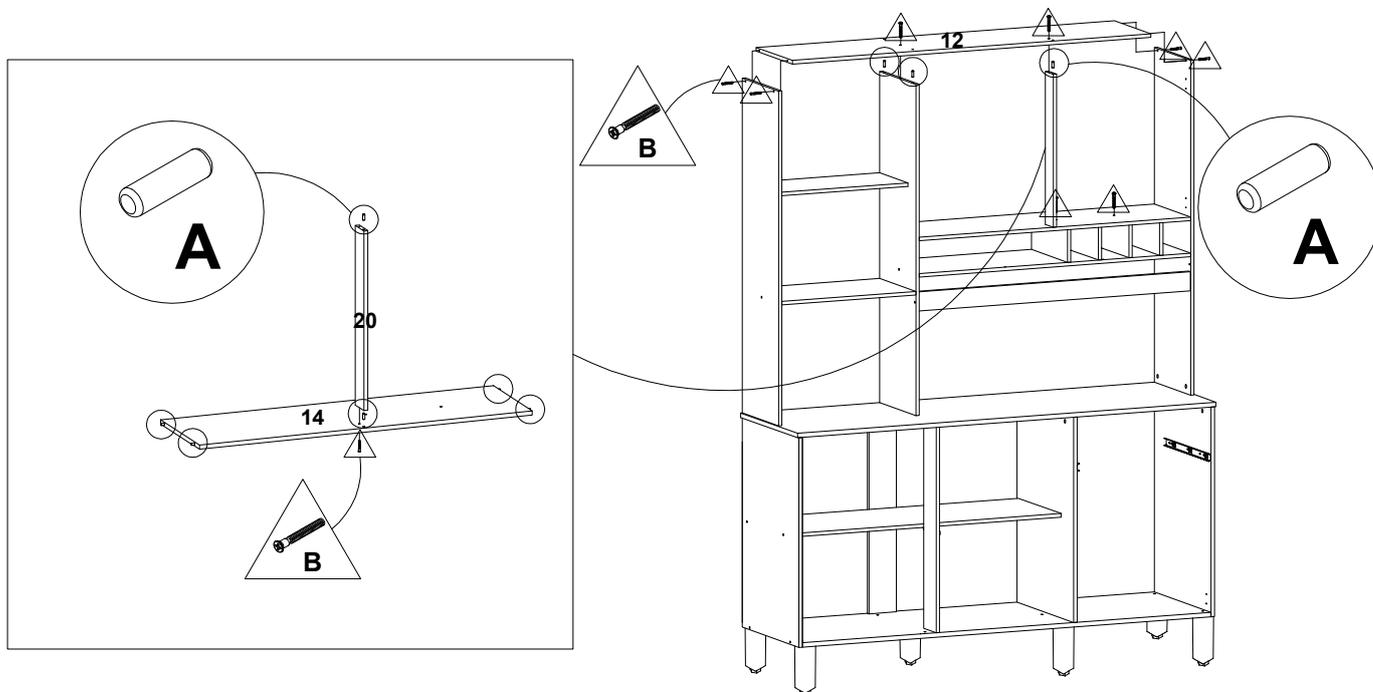
19° - Fixe os fundos com prego 8x8, garra para fundo e parafuso Flang PHS 3,5x12 c/ pont.
