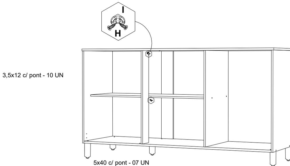
9º - Fixe as laterais Superiores no tampo inferior com com parafuso e tambor minifix e cavilhas 6x20.
