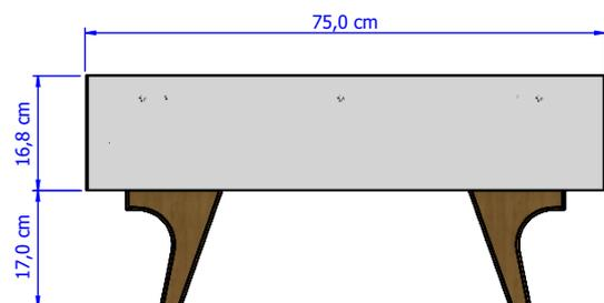
\*340 x 750 x 480mm: medidas nominais de Altura x Largura x Profundidade do gabinete montado.
