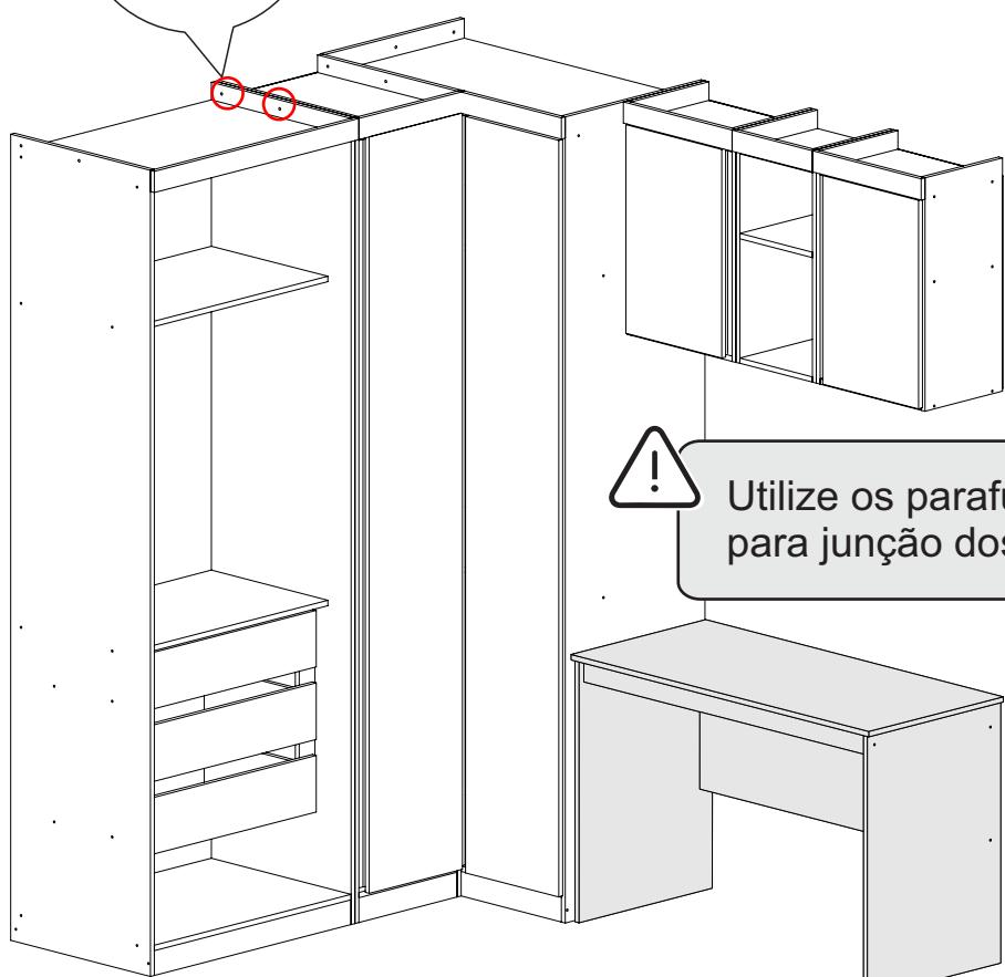
! Utilize os parafusos {C} para junção dos módulos.
