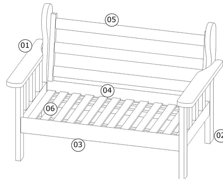
\* A fixação das barras nos pés é feita com parafuso Philips 100mm, cavilhas, arruelas e porcas;
