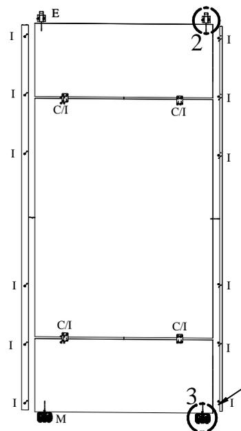
Na fixação dos perfis utilizar o parafuso letra (I) 3,5 x 14 cab flangeada.
