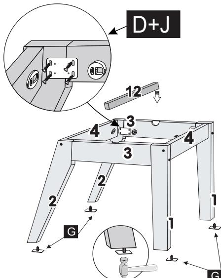
5º - FINALIZAR A MONTAGEM PARAFUSANDO O ASSENTO NO CHASSI DE PÉS UTILIZANDO CANTONEIRAS 2 e 4 FUROS + PARAFUSOS 3,5X10.
