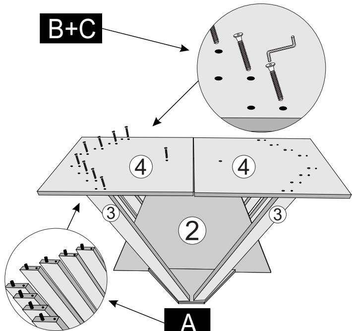
5º - CENTRALIZE A BASE SOBRE O TAMPO, UTILIZANDO AS MEDIDAS ABAIXO E FIXE UTILIZANDO PARAF. FLANGEADO 4,0X30 NAS PEÇAS Nº4, E FINALIZE COM BUCHA AMERICANA E SAPATA REGULAVEL.
