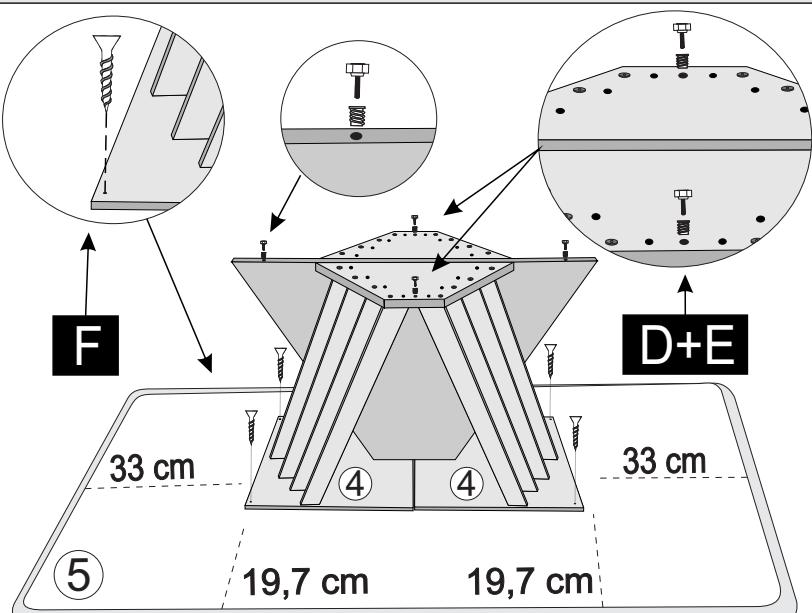
6º - FINALIZE A MONTAGEM COLANDO FITA DUPLA FACE SOBRE O TAMPO N°5 E CENTRALIZE O VIDRO N°6 DIVIDINDO AS RAZÕES.
