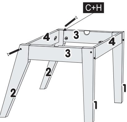
4º - TRAVAR OS PÉS TRASEIROS N.º2 E FRONTAL N.º1 COM AS TRAVAS LATERAIS N.º3 UTILIZANDO CHAPA JUNÇÃO 4 FUROS E PARAF. 3,5X14. EM SEGUIDA, FIXAR AS SAPATAS DESLIZADORAS NOS PÉS.
