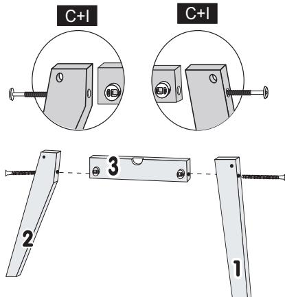
2º - UNIR O CONJUNTO LATERAL COM A TRAVA FRONTAL N°4 UTILIZANDO ANEL FIXADOR + PARAFUSOS 1/4X70 CAB.13mm
