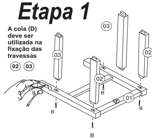
A cola (D) deve ser utilizada na fixação das travessas
