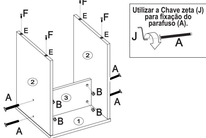
Utilizar a Chave zeta (J) para fixação do parafuso (A).
