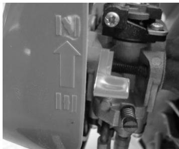
6. Após o primeiro sinal de funcionamento do motor a alavanca do afogador deve ser colocada na posição aberta (1) como mostra a figura ao lado.
