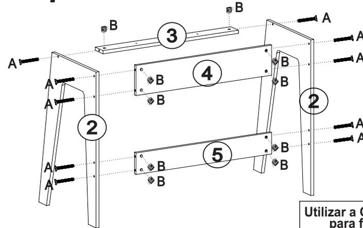
Utilizar a Chave zeta (H) para fixação do parafuso (A).
