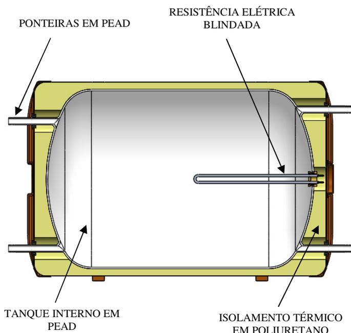
Figura 1 - Vista Interna do Reservatório
