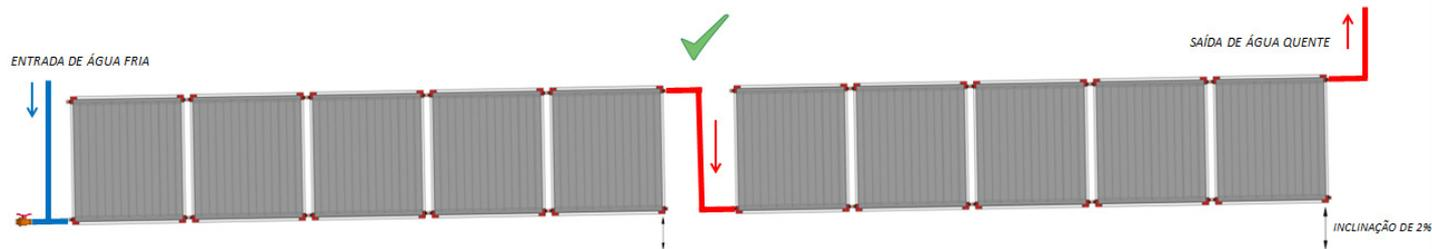
Figura 18 – Fluxo correto de instalação de bateria em série
