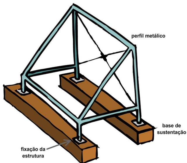
Figura 14 – Suporte de Sustentação das Placas Coletoras
