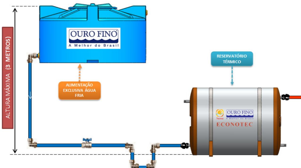
Figura 25 – Altura Máxima Caixa D'água
