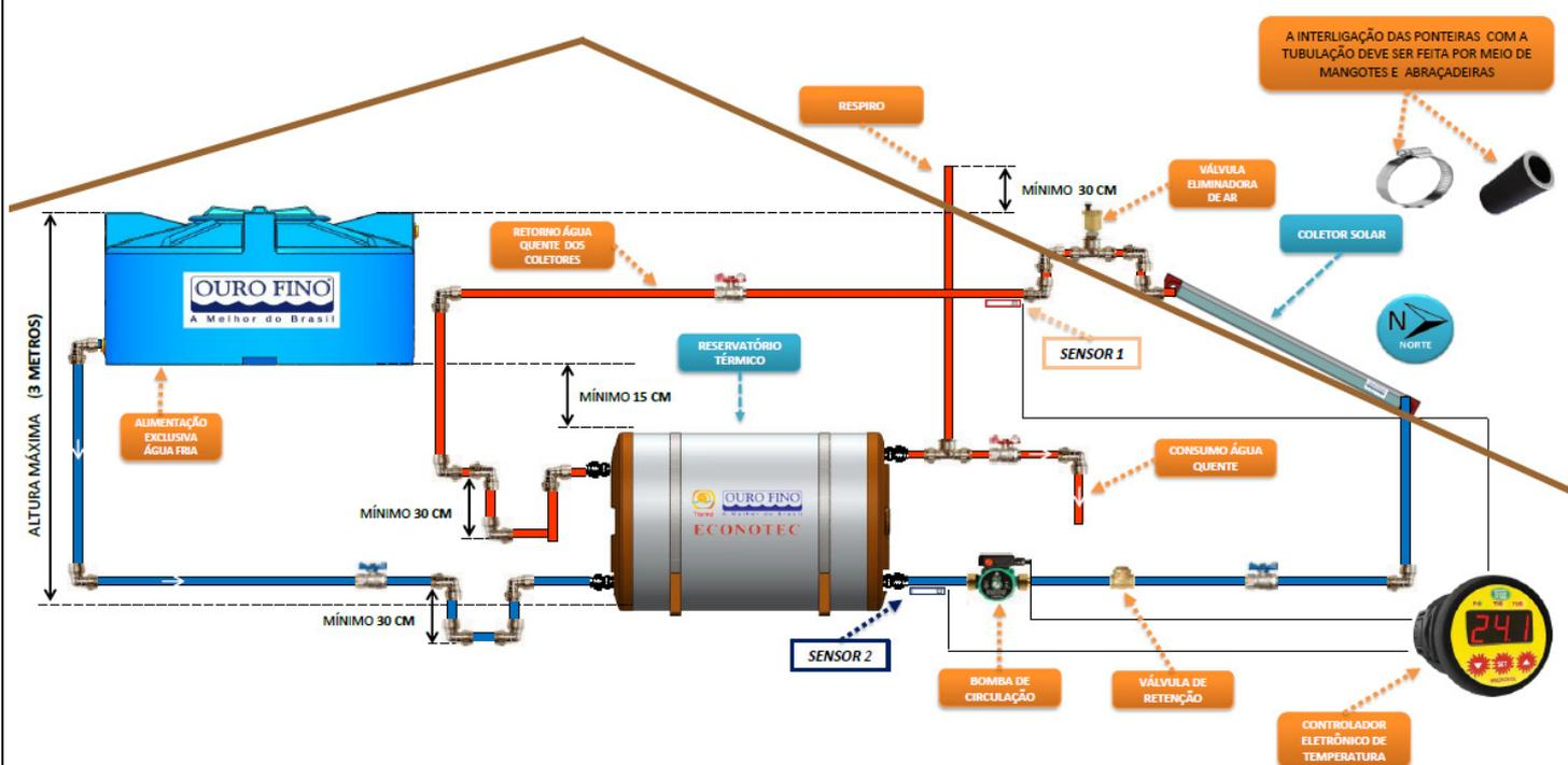
Figura 24 – Esquema Circulação Forçada / Sistema Bombeado
