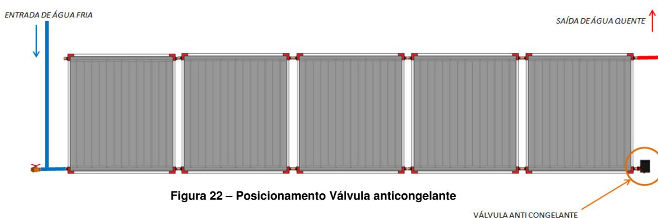
Figura 22 – Posicionamento Válvula anticongelante
