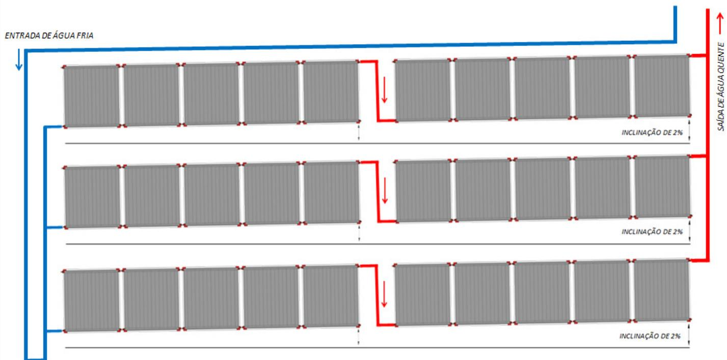
Figura 20 – Montagem tipo “escama”
