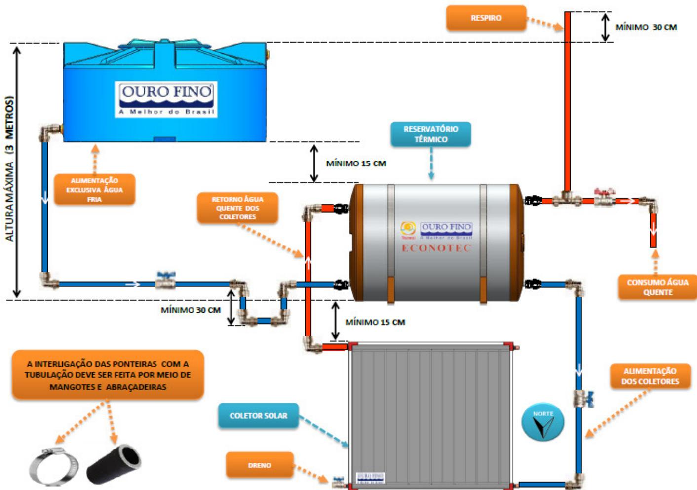
Figura 23 – Esquema Circulação Natural - Sistema Termossifão
