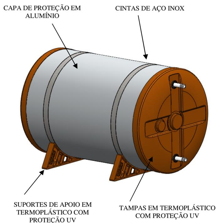
Figura 2 - Vista Externa do Reservatório
