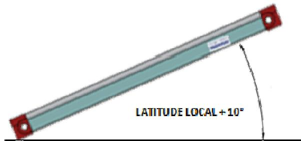
Figura 12 - Inclinação do coletor solar = latitude local +  $10^\circ$
