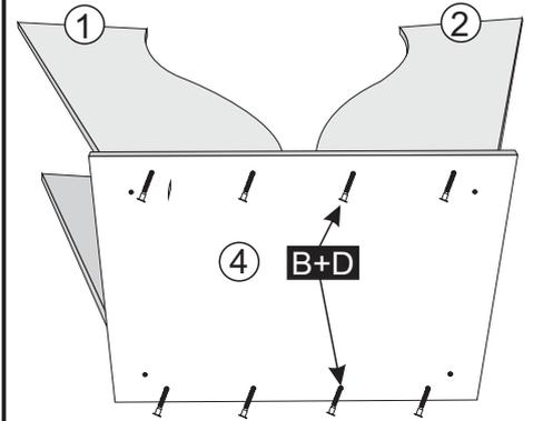
4º- UNIR OS DETALHES Nº4, Nº5 E Nº6 NA SAPATA Nº7 UTILIZANDO PARAFUSOS 1/4X110 E PORCA GARRA.
