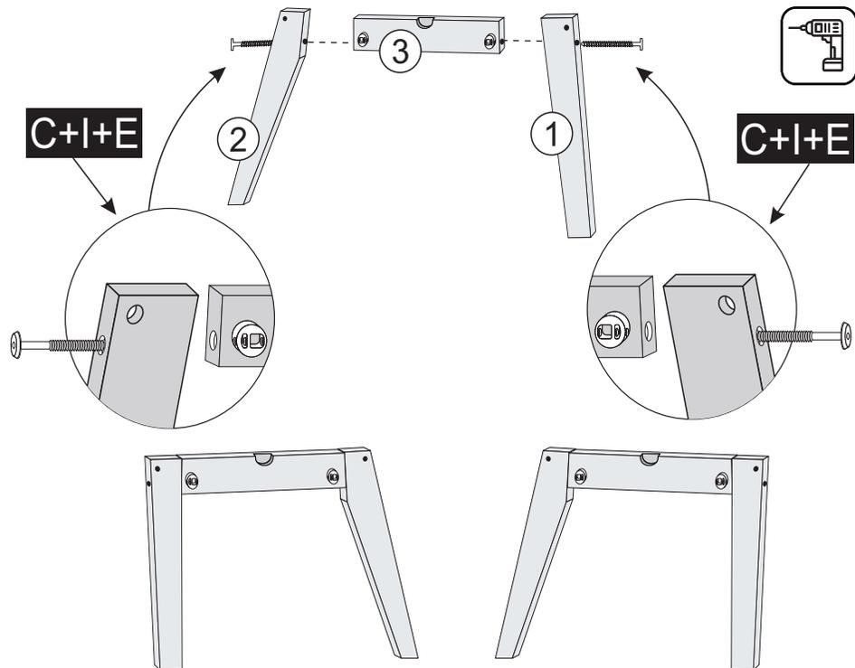
4º - UNIR O CONJUNTO LATERAL COM A TRAVA FRONTAL E TRASEIRA N.º4 UTILIZANDO ANEL FIXADOR+PARAFUSOS 1/4X70 CAB. 13mm. APERTE OS PARAFUSOS COM CHAVE ALLEN ZETA.
